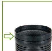
**03.** Verwenden Sie einen TQ Air-Verbinder zum Zusammenfügen von Rohren und Bögen. Platzieren Sie den Verbinder bis zu seiner Mittellinie auf das erste der zu verbindenden Rohre/Bögen. Stellen Sie sicher, dass der Verbinder in der Wellung sitzt, wie in der Zeichnung dargestellt.
