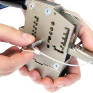
4) insérer la goupille dans le logement du diamètre choisi
