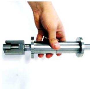
11) faire pivoter la butée puis manœuvrer la coulisse jusqu'à la butée pour ôter le calibre
