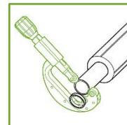
**06.** Um ein gerades Rohrende zu erhalten, schneiden Sie 30 mm des Mediumrohrs mit einem geeigneten Rohrschneider ab.
