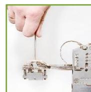
**04.** Heben Sie die Messerhalterung an und schieben Sie den Handschäler am Kalibrierdorn in Richtung PB-Mediumrohr.
