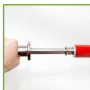
**02.** Schieben Sie den Kalibrierdorn der richtigen Größe so weit wie möglich in das PB-Mediumrohr. Stellen Sie sicher, dass das Mediumrohr stabil ist.
