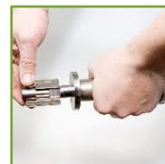
**08.** Entfernen Sie den Kalibrierdorn von Hand oder mit Hilfe des Kalibrierdorn-Demontagewerkzeugs.
