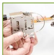
**03.** Stellen Sie den korrekten Durchmesser des Mediumrohrs am Schäler ein: Entfernen Sie den Stift, schieben Sie den Schälerarm auf den zu schälendem Durchmesser und stecken Sie den Stift wieder ein.
