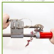
**06.** Schälen Sie im Uhrzeigersinn durch leichtes drehen des Handschälers. Nicht schieben! Achten Sie darauf, dass die entfernte EVOH-Schicht nicht zwischen der Messerhalterung und dem zu schälendem Mediumrohr gerät.
