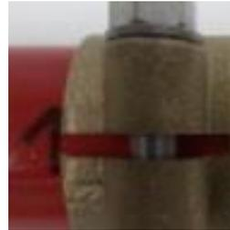
07. S'il y a un espace (raccords de diamètres ≤ 63mm) ou un espace > 7mm (raccords de diamètres > 63mm, laissez le raccord à compression se reposer pendant 24 heures. Resserrer le boulon après 24 heures en respectant le couple de serrage.
