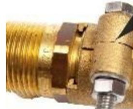
06. Inspecter après 30 min. Le raccord est bien monté si : Il n'y a plus d'espace (raccords de diamètres ≤ 63mm) ou un espace maximal de 7 mm pour les raccords de diamètres >63mm.
