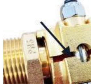
07. S'il y a un espace, laissez le raccord à compression se reposer pendant 24 heures. Resserrez le boulon après 24 heures en respectant le couple de serrage.
