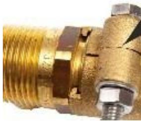
05. Serrer le boulon jusqu'à ce que le manchon de serrage soit fermé. Pour les raccords de diamètres >63mm, un espace de 3 à 7 mm est autorisé. Resserrer le boulon après 30 min.
