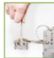
Remonter le porte lame et faire glisser l'appareil sur le calibre en direction du tube
