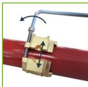
**01.** Öffnen Sie die Spannhülse mit Hilfe des Spreizbolzens und eines Inbusschlüssels. Setzen Sie die Spannhülse auf das Mediumrohr.
