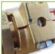
**05.** Ziehen Sie die Verschraubung so lange an, bis die Spannhülse geschlossen ist oder das erforderliche Anzugsmoment (siehe Tabelle) erreicht ist. Ziehen Sie die Schrauben nach 30 Minuten noch einmal nach.
