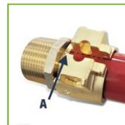
**03.** Platzieren Sie die Spannhülse so, dass die Laschen (A) mit der Nut an der Spannhülse fluchten. Wenn der Schraubensatz nicht montiert werden kann, die Spannhülse mit Hilfe einer Rohrzange schließen.
