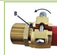
**04.** Beginnen Sie mit dem Anziehen der Verschraubung: Stück für Stück um dem Rohr die nötige Zeit zum Anpassen zu geben. Stellen Sie sicher, dass das Rohr immer bündig mit dem Verbinderboden (B) bleibt.
