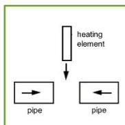
01. Placer medierøret eller fittingsdel i maskinen. Fortag høvling og kalibrering af ende flader. Placer varmespejlet mellem de dele, der skal svejses.
