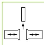
04. Efter endt varmesivetid trækkes rørene fra hinanden og svejsespejlet fjernes.
