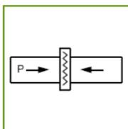
03. Herefter tages trykket af maskinen imens røret stadig er samlet. Lade varmen sive ind i materialet uden at der er trykbelastning (varmesivetid).
