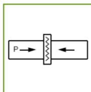
02. Opbyg fortryk til angivet vulstbredde er opnået, ved hydraulisk at trykke rørender imod varmespejlet. Indtil en vulstbredde på 1-2 mm er opnået hele vejen rundt på røret. (se tabel).
